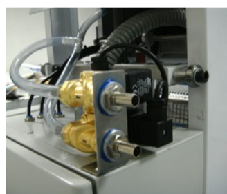
Vannes à vide et gaz
